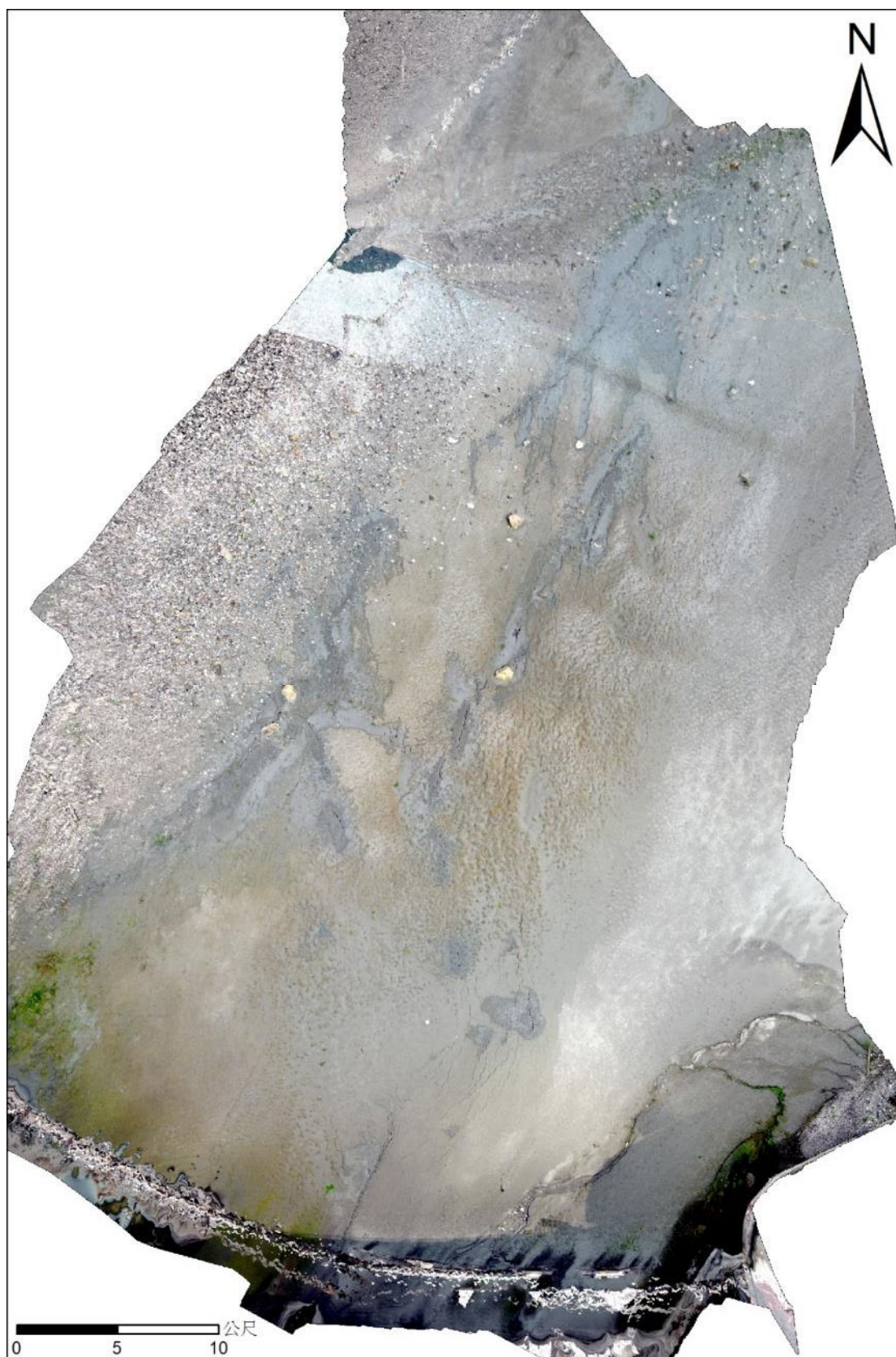
圖 22、4 月 23 日地震後，花蓮大橋噴沙現象南北延伸約 40 公尺。 （謝有忠拍攝）
