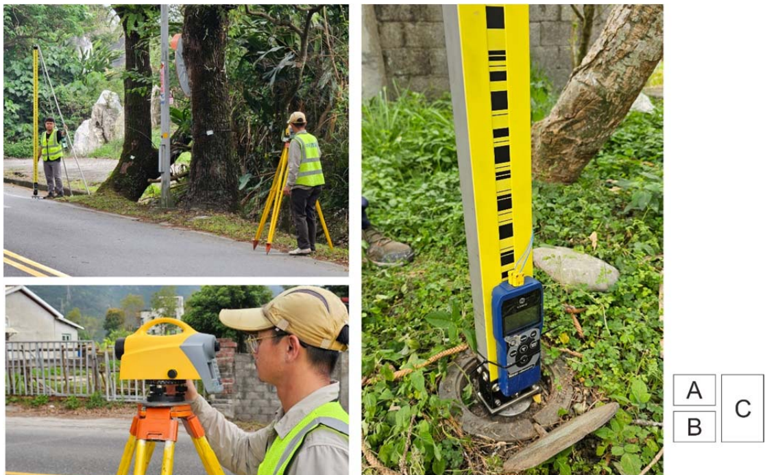
圖 4：精密水準測量情形。(A)觀測人員觀測水準尺面並記錄讀數(B) 自動精密水準儀(C)水準尺放置水準點之情形
