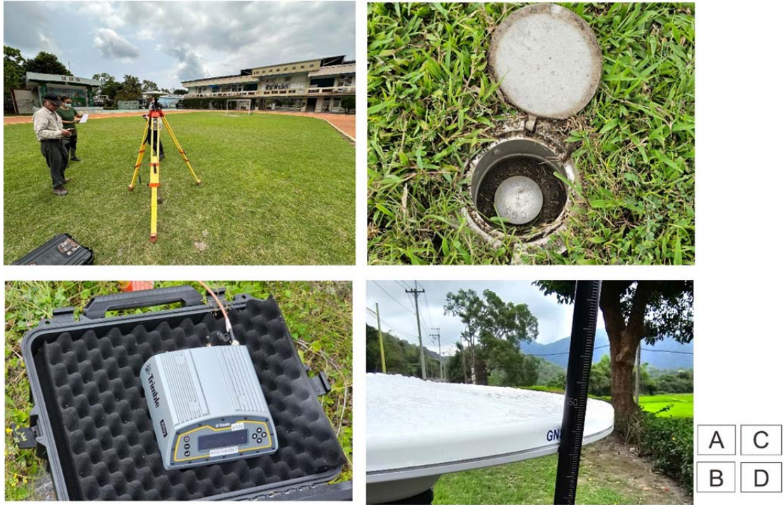
圖 3:GNSS 移動站野外測量觀測情形。(A)架設於基準點上觀測之 GNSS 移動站(B) 雙星雙頻接收儀 (C) 地面埋設之基準點(D)量測天線高度
