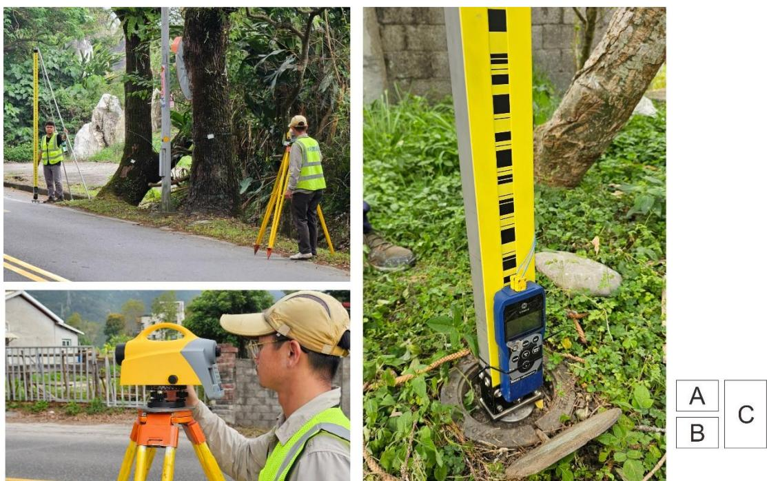
圖 4：精密水準測量情形。(A)觀測人員觀測水準尺面並記錄讀數(B)
