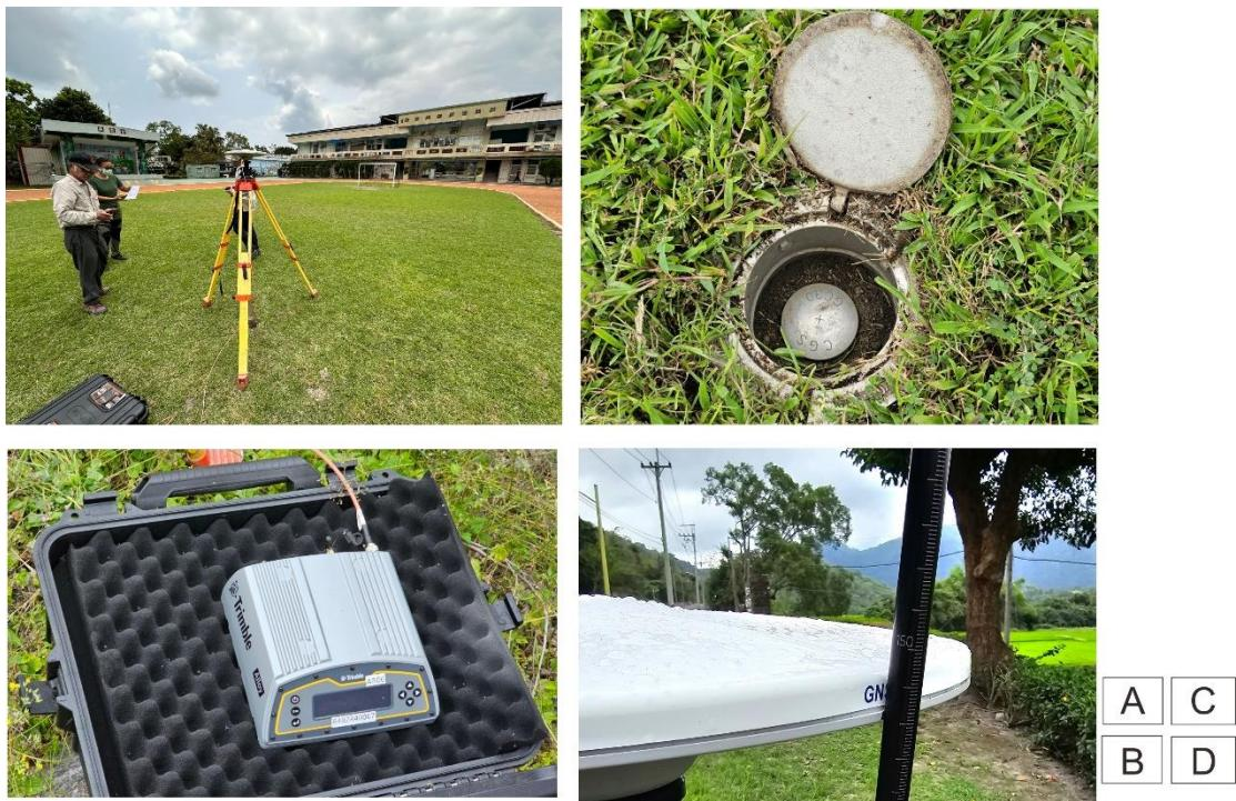
圖 3:GNSS 移動站野外測量觀測情形。(A)架設於基準點上觀測之
