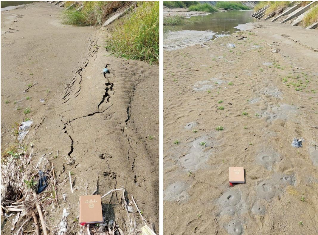
圖 14、荊桐崎河道可見約 300 公尺的河道沉積物被擠壓拱，並伴隨線性分布的噴砂。
