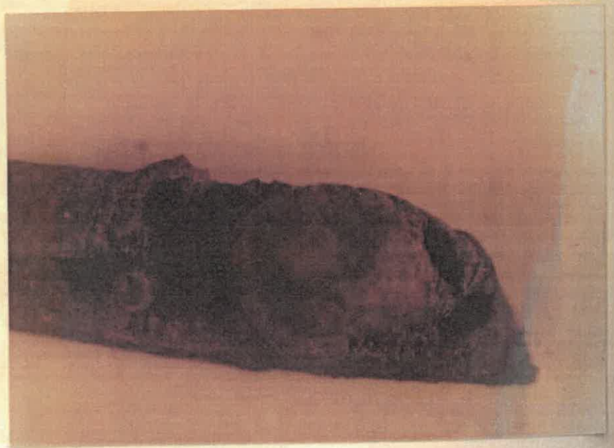
照片十八 引接線斷線處電子顯微
