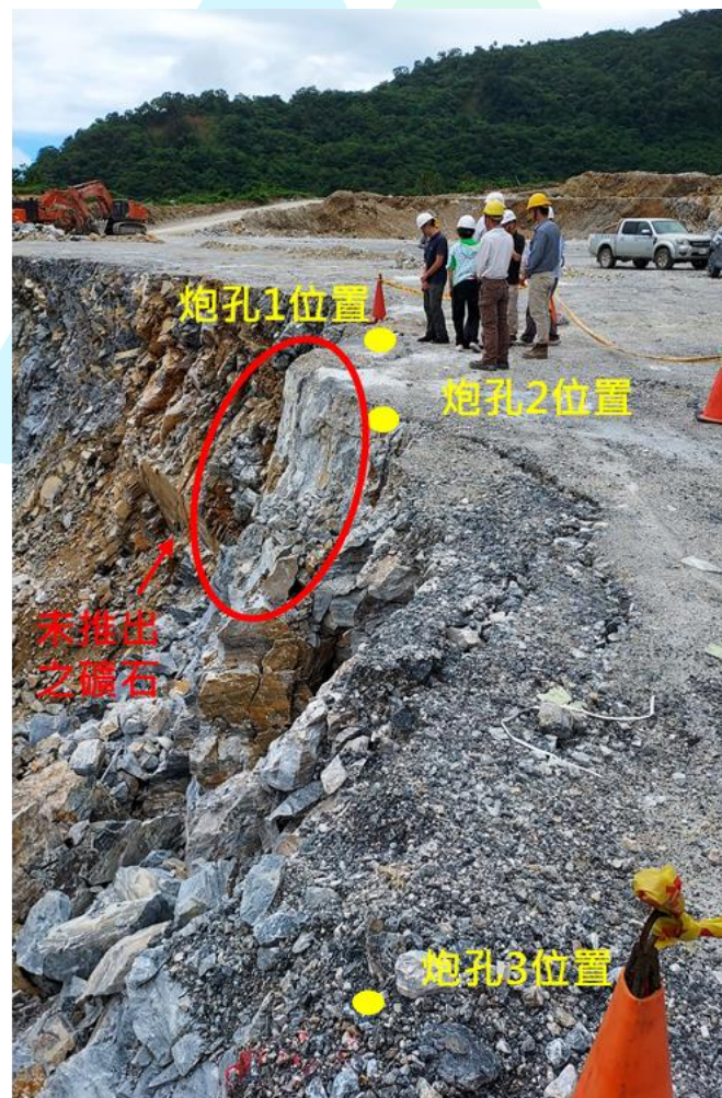
圖 8、側拍炮孔 1 至炮孔 2 間之礦石未推出之現況（114.6.9 攝）
