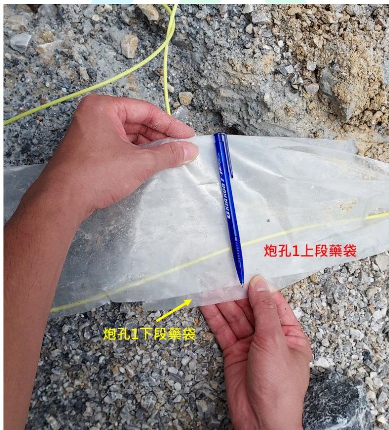
圖 6、測量計算炮孔 1 上下段藥袋直徑尺吋 (114.6.9 攝)
